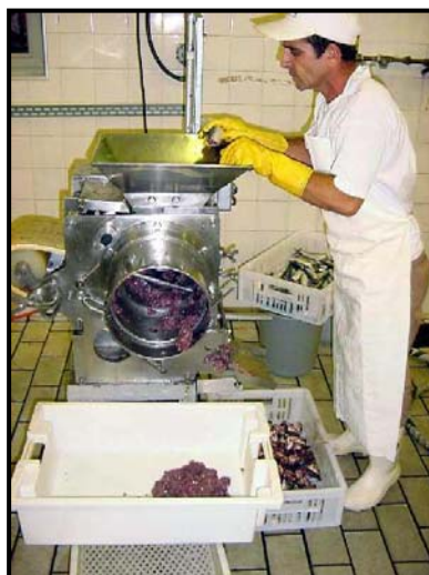
Figura 2 – Equipamento de extração mecânica de espinhas. Fonte: INSTITUTO DE PESCA DE SÃO PAULO, 2008.
